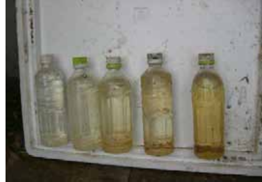
写真6 消石灰を加え、放置後
